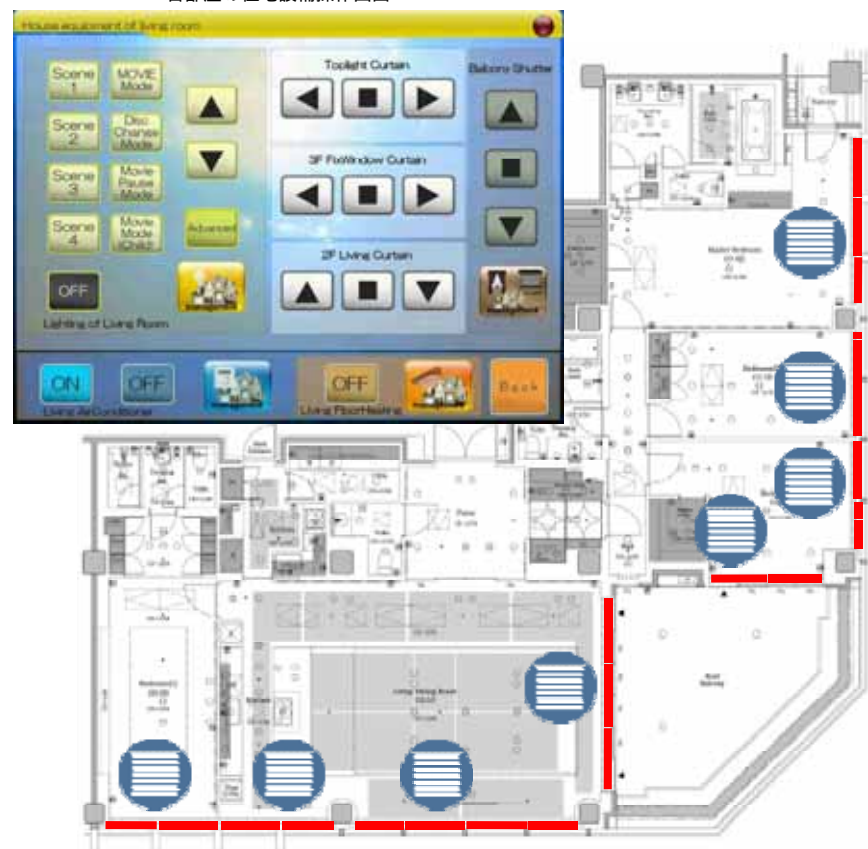
各部屋の住宅設備操作画面
