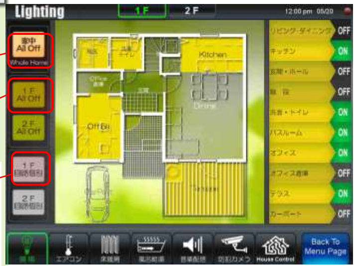
間取り図に各部屋の照明 ON/OFFを表示(照明管理画面)
