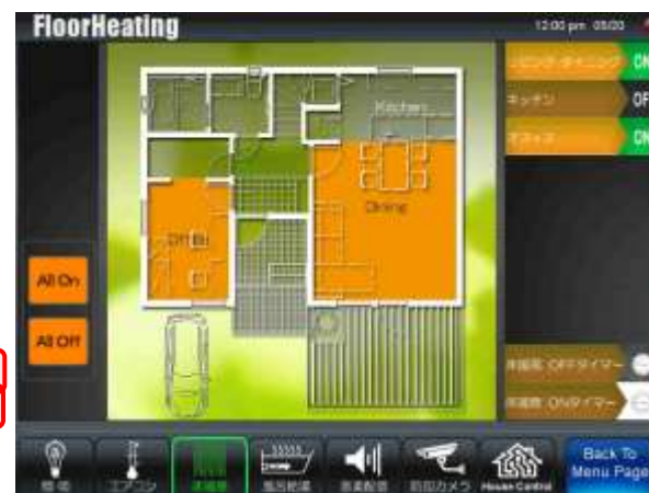
間取り図に各部屋の床暖房 ON/OFFを表示(床暖房管理画面)
