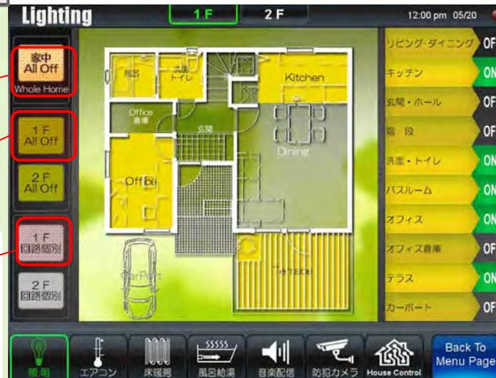
間取り図に各部屋の照明 ON/OFFを表示(照明管理画面)
